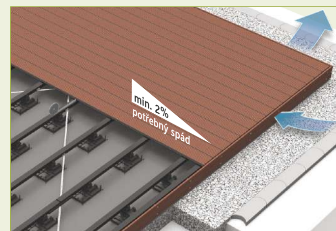
s lištou s drážkou/profem spáry P5 jen se zvýšenou konstrukcí min. 14,3 mm, se spádem min. 2% a povinně zajistit dostatečné spodní a zadní odvětrávání (např. použití ventilační mřížky, vzdálenost kosočtvercových profilů)
