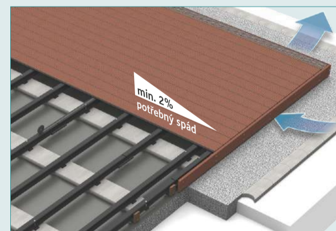
s lištou s drážkou/profem spáry P5 jen se zvýšenou konstrukcí min. 14,3 mm, se spádem min. 2% a povinně zajistit dostatečné spodní a zadní odvětrávání (např. použití ventilační mřížky, vzdálenost kosočtvercových profilů)
